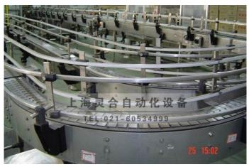
顶板链输送机分为塑钢与不锈钢两种。
